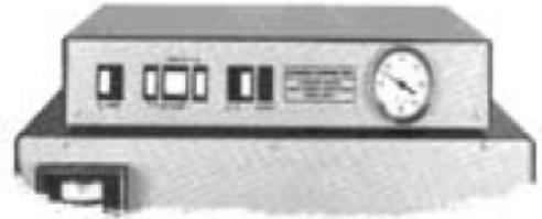
ATCS 保护系统是为对紧急情况（如没电）作出适当的反应以及在正常操作的情况下协助操作员开启和关闭 PAHP 而设计的。
