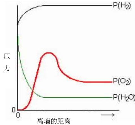
2.氢气运送所有的杂质到墙壁。越靠近墙壁杂质的浓度越高。
