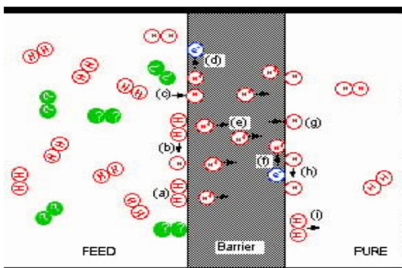
在提高的压力中的双原子氢气被吸附 (a) 在的钯合金隔板上，在这个隔板上它可以分离成吸附在隔板上 (c) 的单原子 (b)。其他气体种类也吸附，但是不会溶解在隔板上。
